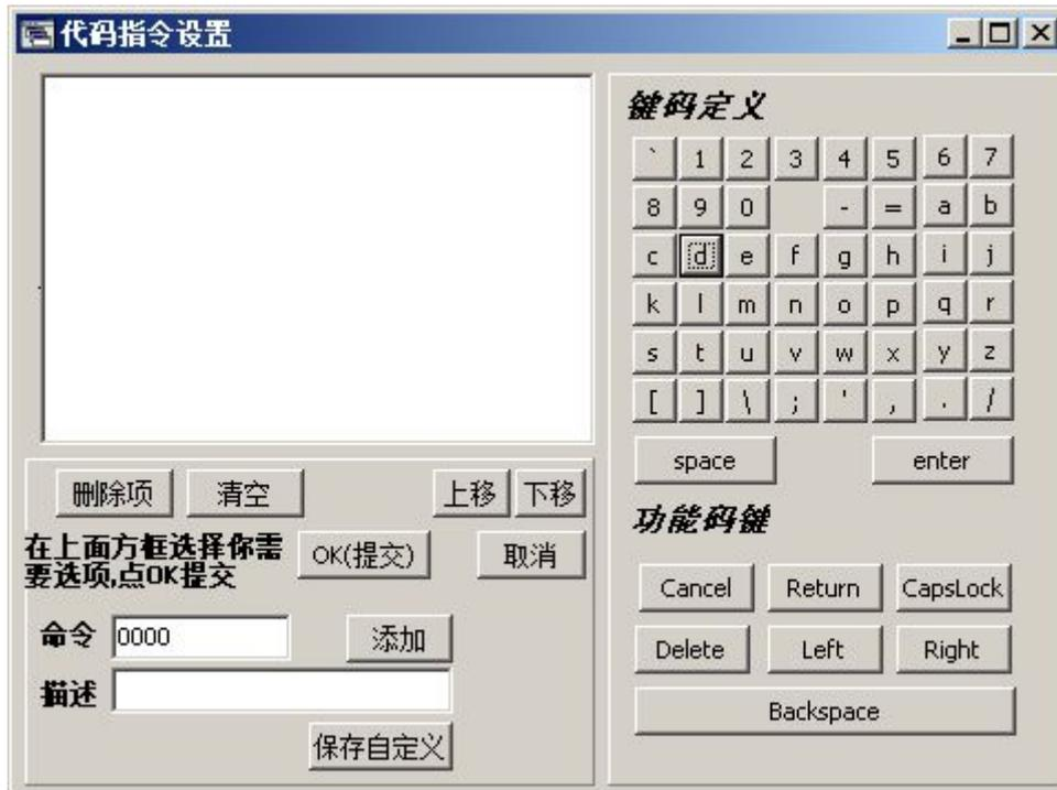
当选择指定的按键后，会自动返回一对应的键值，一般键值使用 16 位数据，当使用字母键盘输入时，字母键高字节对应大写字母 ASCII 值，低字节对应小写字母 ASCII 值，如果键盘中有定义 CapsLock 键，按下该按键后会自动切换大小写显示。比如选择键码 ‘d’，则返回键值 0x4464，使用 ASCII 录入控件时，点击 ‘d’ 显示 ‘d’，如果先按下 CapsLock 键，则点击 ‘d’ 显示 ‘D’。
